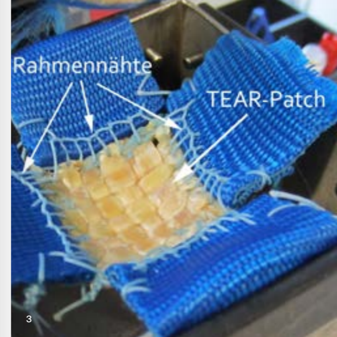
Abb. 3: Der TEAR-Patch ist an allen vier Seiten an ein reißfestes Dacrontape vernäht und in der Haltevorrichtung eingespannt. Nach der Impression mit einer Edeltstahlkugel bis zum Maximalversagen zeigt sich ein Ausreißen aus der Verankerung bei intaktem TEAR-Patch.
