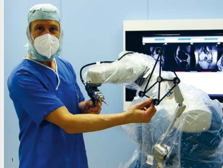
Abb. 1: Prof. Dr. Siebold im Operationssaal am Mako@Smartroboter. Die Antenne sorgt dafür, dass die Position des Kniegelenks genau vermessen werden kann, und mit der Fräse lässt sich der geschädigte Knorpel millimetergenau bearbeiten.
